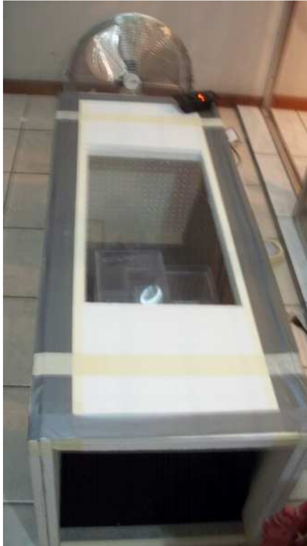
Figura 143. Secuencia de prueba 4. Túnel de viento con ventilación mecánica. Túnel de viento y dispositivos para realizar las pruebas
