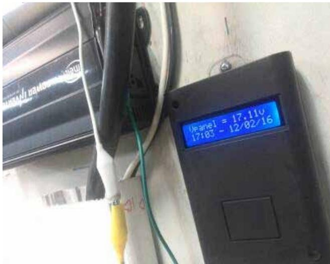
*Fig. 4.5. Vista frontal prototipo de monitoreo instalado junto a la acometida del panel solar*
