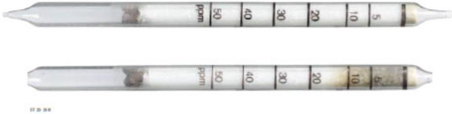
Función de cálculo de concentración según la carrera y reacción química en tubo Dräger 67 28-701 para medir combustible benceno en aire
