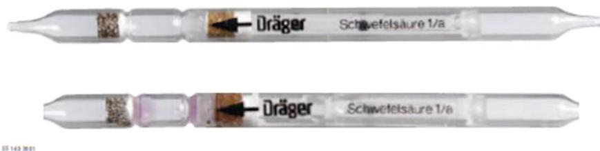
Tabla 6. Función de cálculo de concentración según la carrera y reacción química en tubo Dräger 67 28-781 para medir ácido sulfúrico en aire
