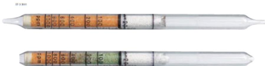
Función de cálculo de concentración según la carrera de bomba automática Dräger X-act 5000 y reacción química en tubo Dräger 67 26 665 para medir acetaldehído.
