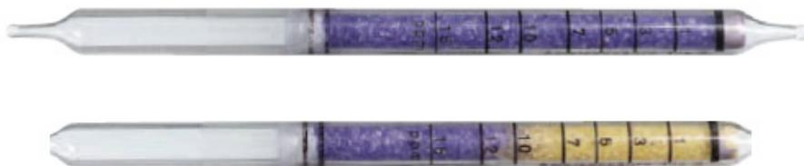
Función de cálculo de concentración según la carrera de bomba automática Dräger X-act 5000 y reacción química en tubo Dräger 67 22-701 para medir ácido fórmico en aire.
