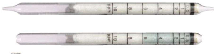
Función de cálculo de concentración según la carrera de bomba automática Dräger X-act 5000 y reacción química en tubo Dräger 67 28-781 para medir anilina 0.5/a en aire.
