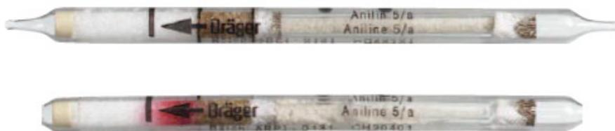
Función de cálculo de concentración según la carrera de bomba automática Dräger X-act 5000 y reacción química en tubo Dräger CH 20 401 para medir anilina 5/a en aire (Dräger, 2012).
