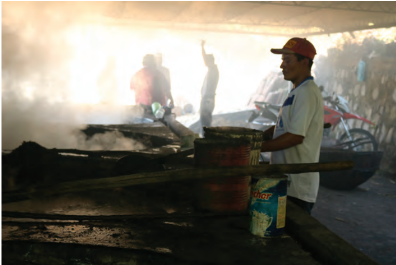
Fotografía 83. Proceso de concentración y punteo del dulce de la caña de azúcar, para consolidar la miel que permite obtener el atado de dulce de panela. Fotografía tomada por Miguel Ángel Hernández Vásquez, el día 23/11/2017
