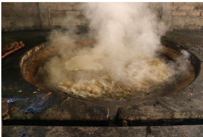
Fotografía 81. Proceso de ebullición del dulce de la caña de azúcar, en proceso para llegar al punto requerido por el puntero (hornero), para pasarlo a los moldes del atado del dulce de panela, el cual está hecho de madera de árbol de mango. Fotografía tomada por Miguel Ángel Hernández Vásquez, el día 23/11/2017.
