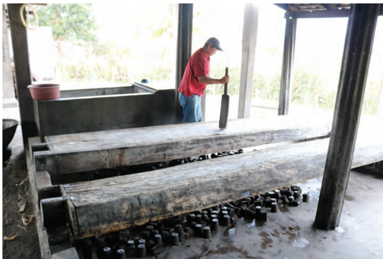
Fotografía 90. Proceso de golpe de percusión para sacar los tarros contenidos en los moldes, diseñados para para obtener los tarros que forman el dulce de panela. Fotografía tomada por Miguel Ángel Hernández Vásquez, el día 23/11/2017.
