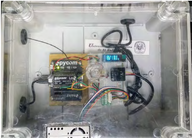
Figura 22. Vista al interior de la carcasa del nodo IoT del sistema diseñado. Fuente: diseño propio.
